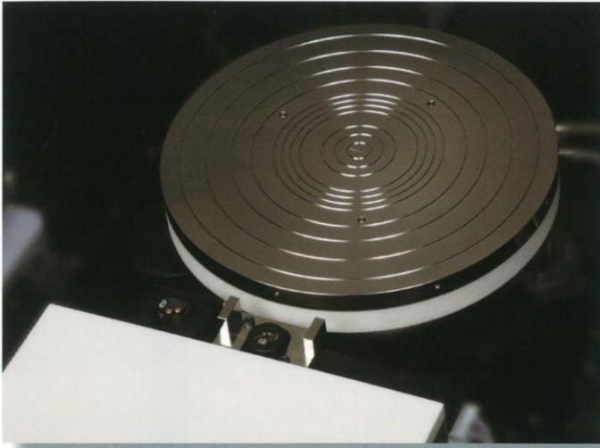
ACCRETECH长年的技术累积的结晶，高刚性Z/θ台盘，可确保先进半导体制程中的多晶粒、多次针测工艺的进行。
