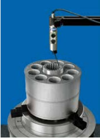
不连续面内径的圆度测量示例
