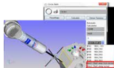
软件根据指定的元素 (倾斜表面) 选择最合适的测针进行测量。
